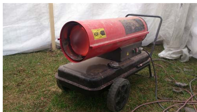
Bild 6. Tre nödvändiga kompisar; 1) Ett 5kW trefas element som svarade för basvärmens dygnet runt utom under soliga dagar då tältet blev till ett växthus och överskottsvärmen behövde ventileras bort. Som kallast var det minus 4C på natten och trots det blev tempen aldrig kritiskt låg med elementet inkopplat. 2) en 20 kW dieselvärmare som på nolltid höjde tempen till bastuvärme. Bra när det skulle målas på förmiddagen efter en kall natt. 3) en temperatur och relativ luftfuktighetsmätare. Utan den skall inget målningsarbete utföras utomhus. International rekommenderade en rel. luftfuktighet <70% (om högre påverkas glansen negativt samt torktiden förlängs) samt en idealtemperatur runt 12C under målningsstillfället (varmare ger snabbare torkning med mindre möjlighet att "jobba om" en yta om det skulle finnas behov, vid 12C har man kanske någon minut att gå tillbaka och fixa ev. imperfektioner). Självlklart är det helt OK, och till och med önskvärt, med högre temp än 12C efter målningen då färgen skall torka.
