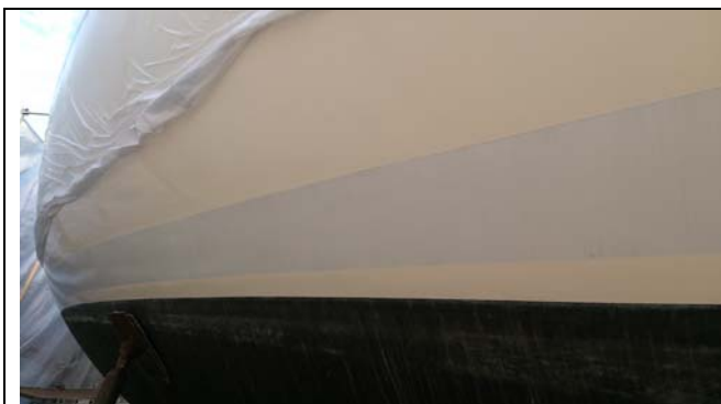
Bild 12. 1:a skiktet grundfärg på plats. Färdigblandad grundfärg som blir över klarar att stå över natten i en burk med lock för användning dagen efter. Saggig rand mot det vita fribordet, men grundfärgens vita kulör mildrar effekten. Värre skall det bli...
