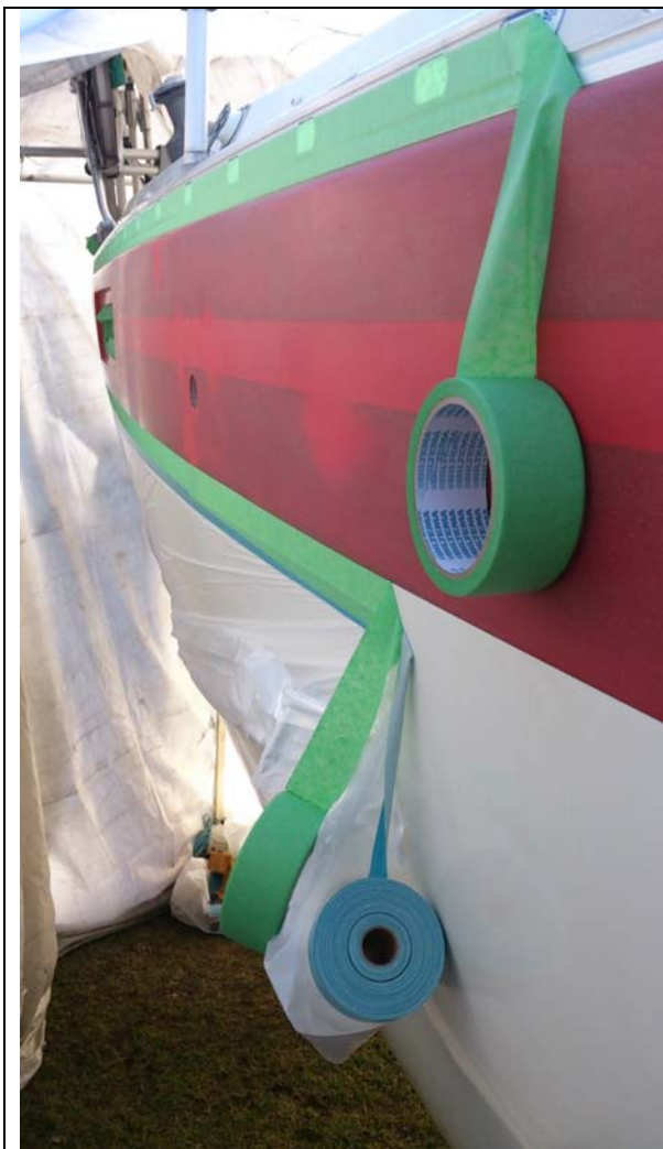
Bild 8. Att maska är ett hästjobb! För första skiktet maskas två linjer för den övre och två linjer för den undre snobbranden. Den översta linjen sätts mot alu-listen och får sitta kvar genom hela målningsjobbet (extremt tidsbesparande beslut!). En skyddsfolie (Biltema 87-054) sätts ca. 25 mm under den översta snobbrandens undre linje. Den sitter kvar genom hela målningsjobbet. Skyddar mot diverse slabb med färg. Som maskeringstejp användes först Biltemas gröna 38 mm (87-7532), vilket visade sig vara ett extremt felbeslut (mer om detta senare).
