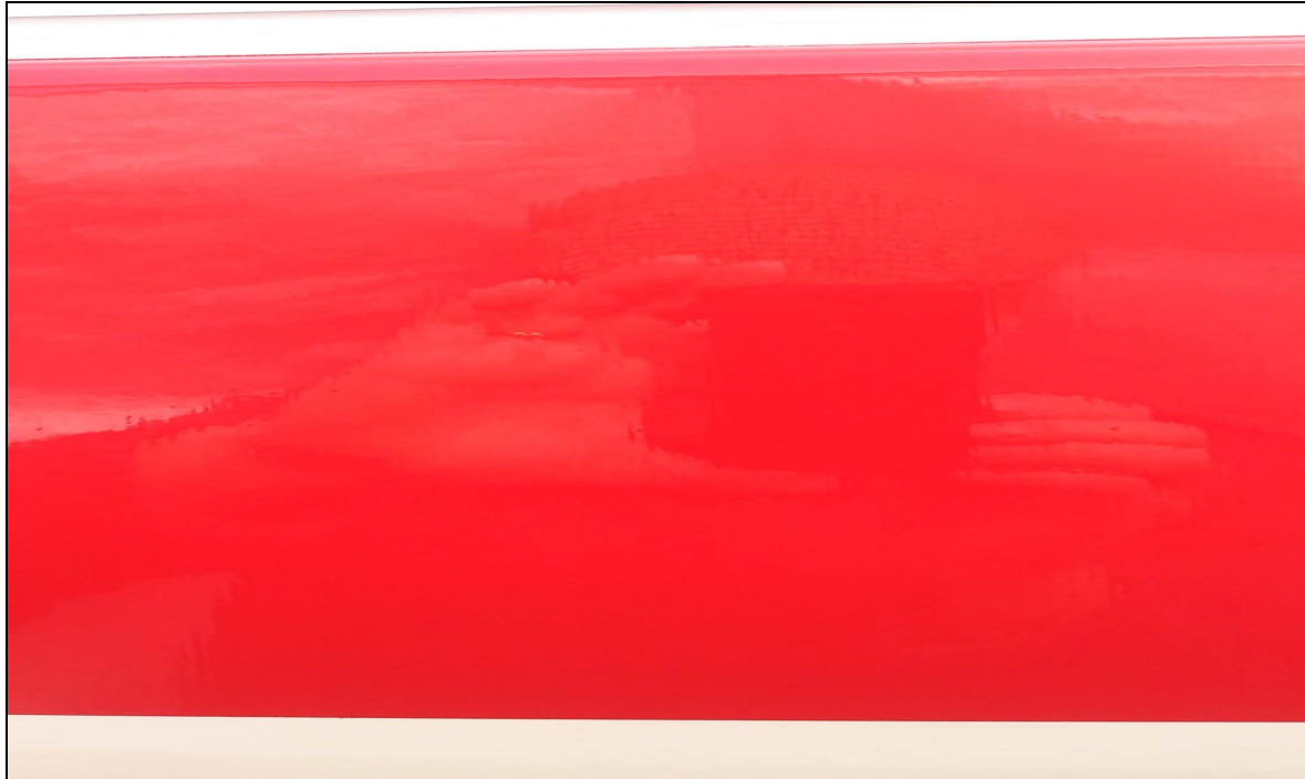
Bild 24. Close-up på slutresultatet. Det blev OK, men kommer att kräva en våtslipning nästa vår när färgen genomhärdat för att få bort viss vågighet som penseln lämnade efter sig samt diverse dammkorn och skräp som sitter i ytan. Inser att penseldragen skulle runnit ut bättre om mer thinner hade använts i topplacken. Men det skulle ökat risken för rinning, vilket syns ännu mer. Alternativt kunde man målat tjockare (låg klart över yttäckning per volymenhet färg som angavs på burken, dvs. målade tunna skikt) men med samma risk för rinning. Ingen lätt balansgång mellan utrinning vs. risk för rinning när en vertikal yta målas.
